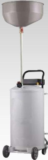
El extractor de aceite es ideal para el cambio de aceite en talleres. Extrae el aceite usado del cárter del motor a través de una sonda que se introduce por la varilla del nivel de aceite; también se puede extraer aprovechando la fuerza de gravedad, con el vehículo subido en el elevador, el aceite usado cae en la bandeja superior, simplificando y agilizando el cambio de lubricante de cualquier vehículo.
