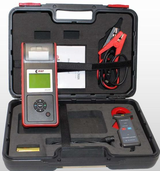
El comprobador de baterías DS-200 utiliza la más avanzada tecnología de pruebas de conductancia, es una herramienta rápida, precisa y segura para la comprobación de baterías, pruebas de arranque y el sistema de carga.
